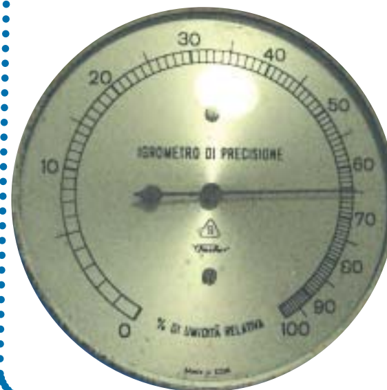
L'IGROMETRO MISURA LA PERCENTUALE DI UMIDITÀ (VAPORE ACQUEO) PRESENTE IN UN VOLUME D'ARIA
