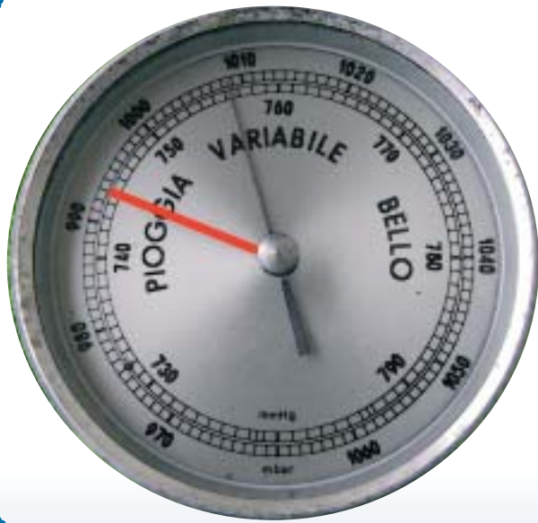
IL BAROMETRO MISURA IL PESO DELLA COLONNA D'ARIA CHE LO SOVRASTA
